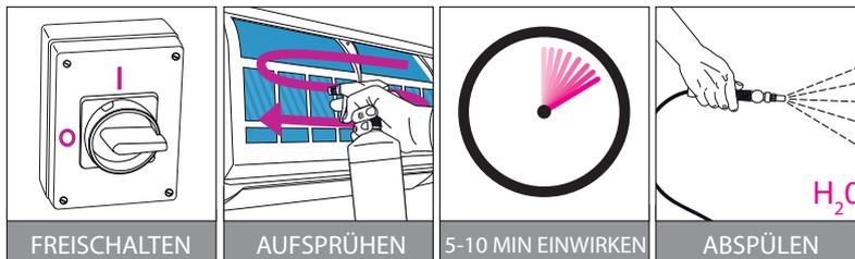
Anlage freischalten und elektrische Leitungen schützen. Reiniger mit einem Niederdrucksprünger in den Wärmetauscher sprühen. Anwendung in einer der oberen Ecken beginnen und dann systematisch seitlich und nach unten fortsetzen. Alle Oberflächen fünf bis zehn Minuten lang nass halten.
