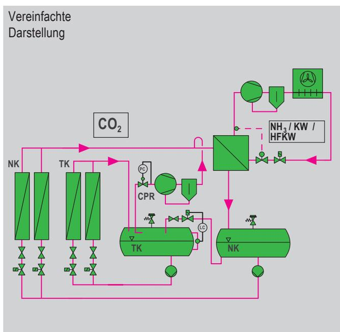
Abb. 30 Kaskadensystem mit  $\text{CO}_2$  für industrielle Anwendung
