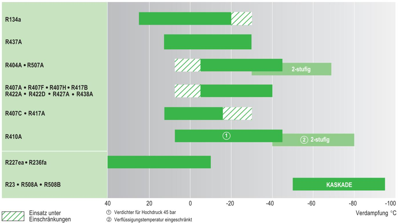
Abb. 34 Anwendungsbereiche von HFKW-Kältemitteln (ODP = 0)
