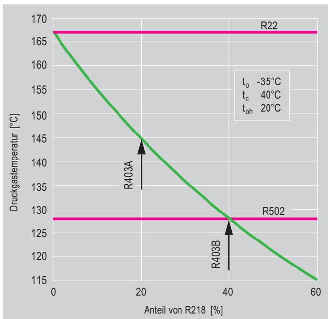
Abb. 13 Auswirkungen der Gemischvariation auf die Druckgastemperatur (Beispiel: R22/R218/R290)
