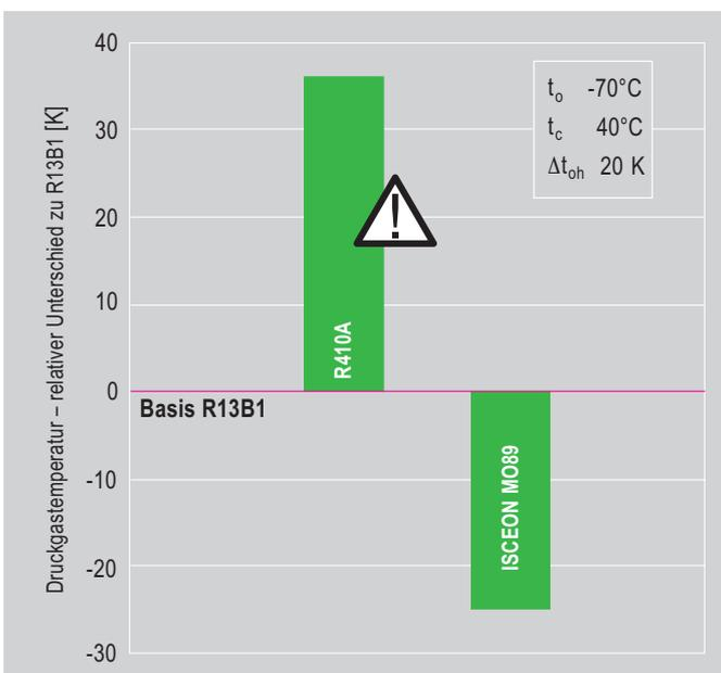
Abb. 33 R13B1/HFKW-Alternativen – Vergleich der Druckgastemperaturen eines 2-stufigen Verdichters
