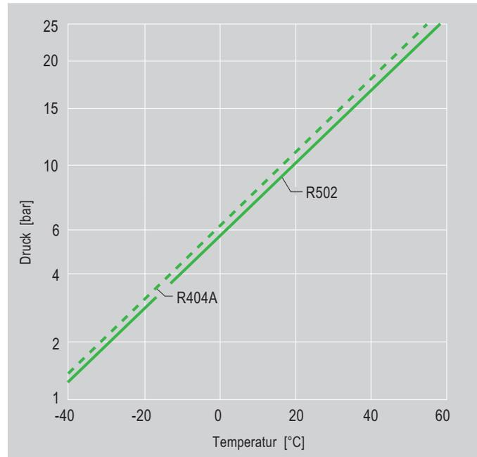
Abb. 12 Drucklagen von R404A im Vergleich zu R502
