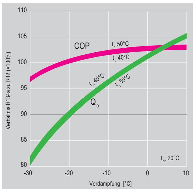
Abb. 8 R134a/R12 – Vergleich der Leistungsdaten eines halbhermetischen Verdichters
