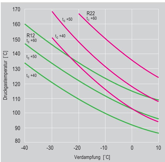
Abb. 6 R12/R22 – Vergleich der Druckgastemperatur eines halbhermetischen Verdichters
