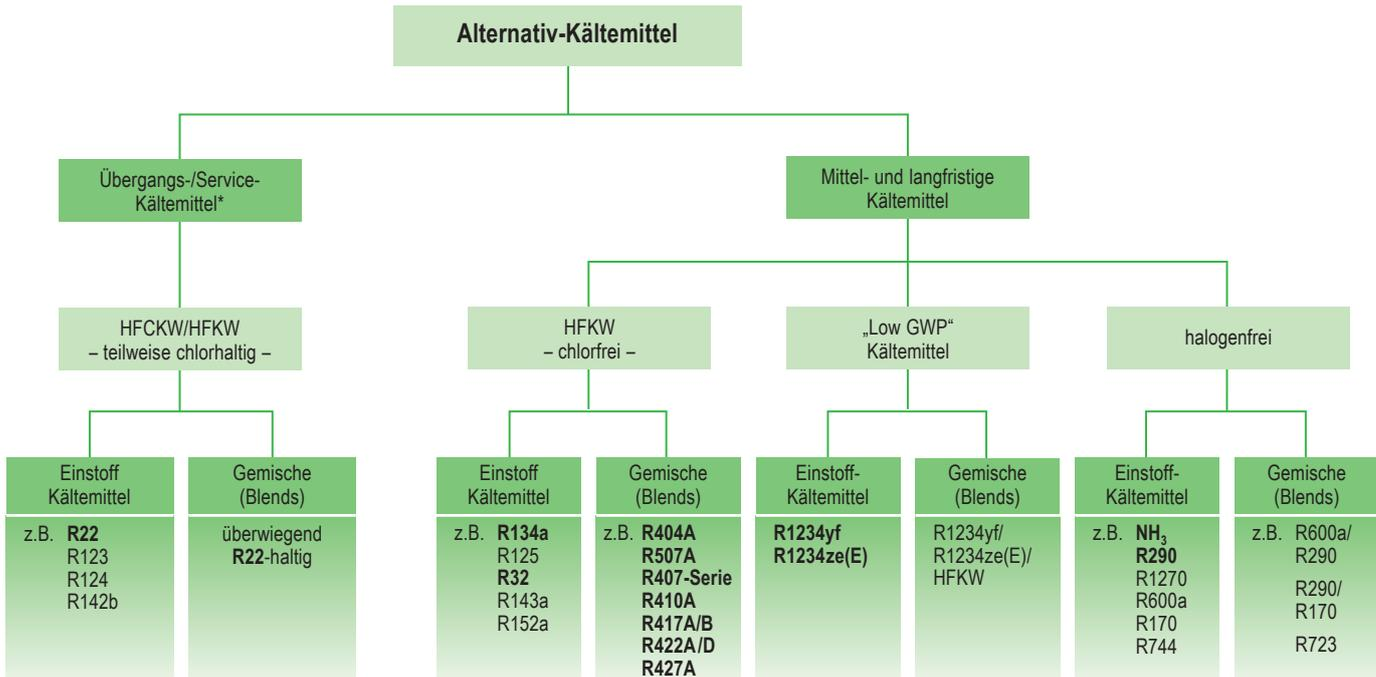
\* Service-Kältemittel enthalten HFCKW als Gemischkomponente. Sie unterliegen deshalb den gleichen gesetzlichen Bestimmungen wie R22 (siehe Seite 8). Bedingt durch die fortschreitende Sanierung von älteren Anlagen ist die Bedeutung dieser Kältemittel inzwischen deutlich zurückgegangen. Teilweise wurde bereits die Produktion eingestellt. Aus Gründen der Entwicklungsgeschichte von Service-Gemischen werden diese Kältemittel jedoch im vorliegenden Report weiterhin behandelt.
