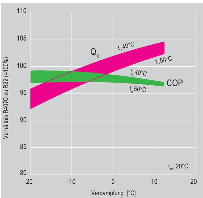
Abb. 19 R407C/R22 – Vergleich der Leistungsdaten eines halbhermetischen Verdichters
