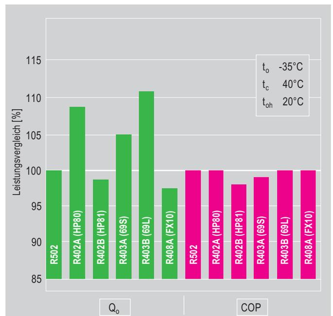
Abb. 14 Vergleich der Leistungsdaten eines halbhermetischen Verdichters
