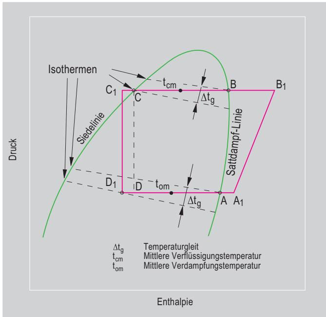
Abb. 11 Verhältnisse bei Verdampfung und Verflüssigung zeotroper Gemische
