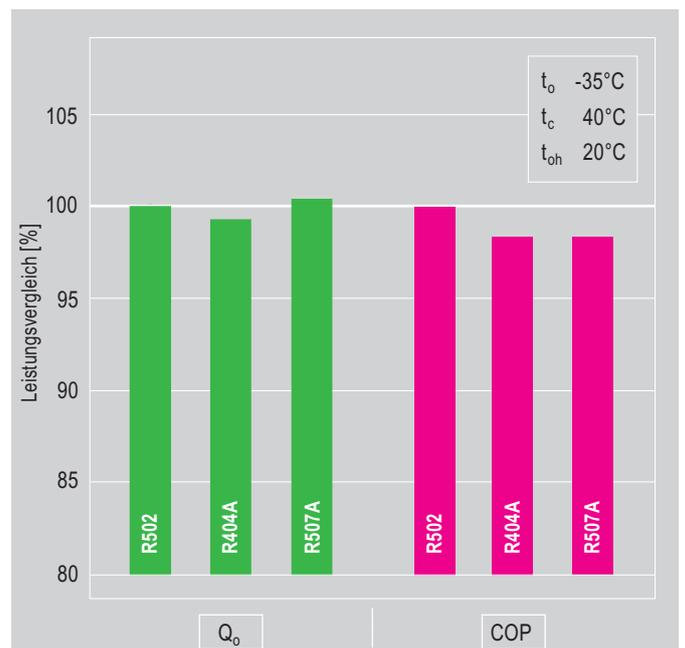
Abb. 16 Vergleich der Leistungsdaten eines halbhermetischen Verdichters
