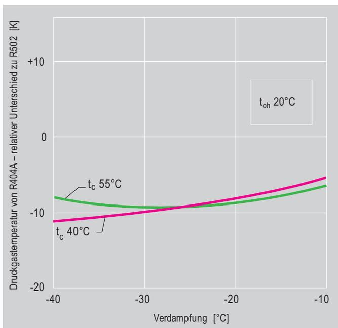
Abb. 15 R404A/R502 – Vergleich der Druckgastemperaturen eines halbhermetischen Verdichters
