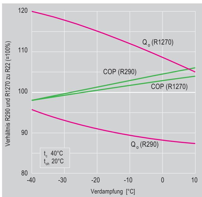
Abb. 26 R290/R1270/R22 – Vergleich der Leistungsdaten eines halbhermetischen Verdichters
