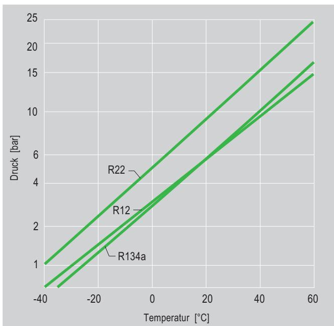
Abb. 10 R134a/R12/R22 – Vergleich der Drucklagen
