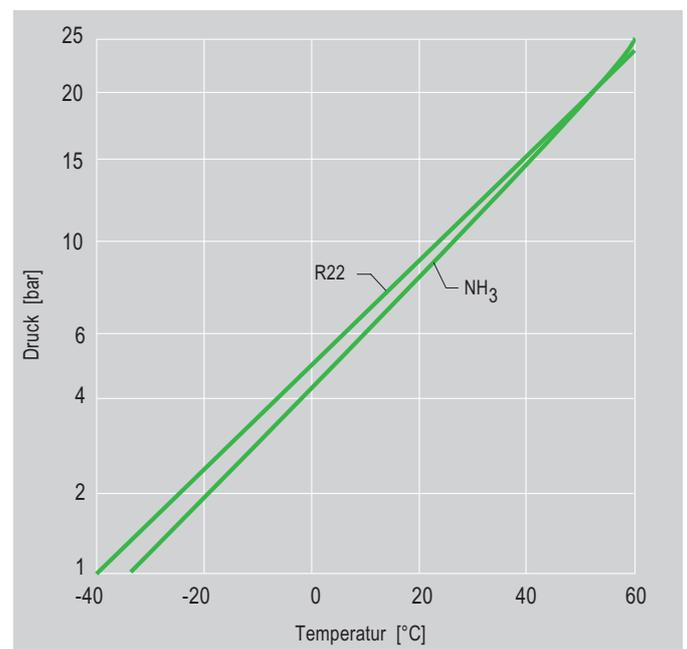
Abb. 25 NH<sub>3</sub>/R22 – Vergleich der Drucklagen
