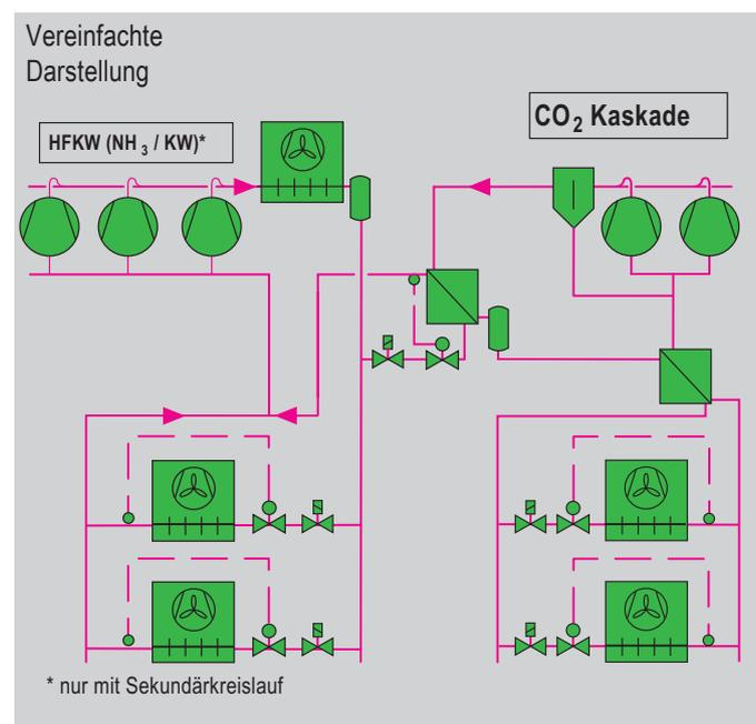
Abb. 31 Konventionelle Kälteanlage kombiniert mit  $\text{CO}_2$ -Tiefkühlkaskade
