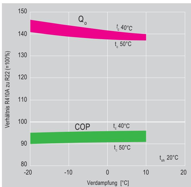
Abb. 21 R410A/R22 – Vergleich der Leistungsdaten eines halbhermetischen Verdichters
