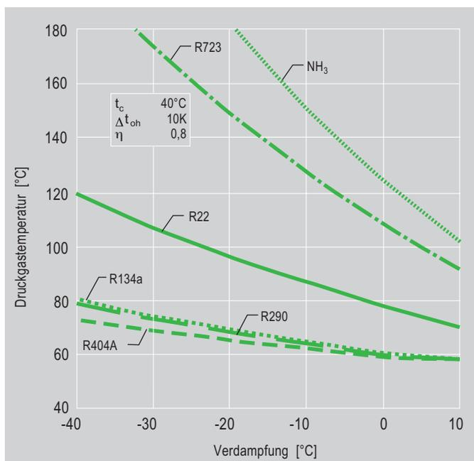
Abb. 24 Vergleich von Druckgastemperaturen
