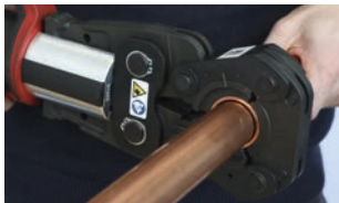
9c. Verpressung durchführen
