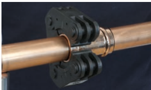
9a. Die Press-Schlinge rechtwinklig ansetzen
