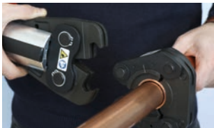
9b. Die Zwischenbacke ansetzen
