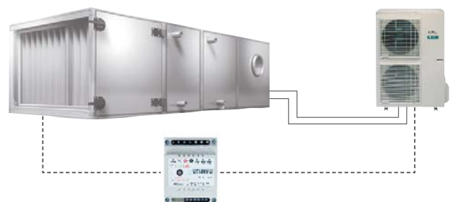
Lüftungsanlage mit INV-Modul
