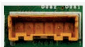
Anschlusstecker mit Litzen (500 mm) für alle T10-Funktionen
