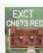
Anschlusstecker mit Litzen (2000 mm) für Thermostat-AUS- bzw. Leckdetektor-Eingang
