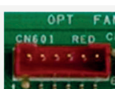
Steckverbinder für den Anschluss an die Platine von PACi NX-Innengeräten zur Bereitstellung von OPT-Funktionen
