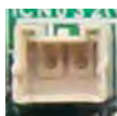
Anschlusstecker mit Litzen (2000 mm) zur Ansteuerung eines externen Lüftungsgeräts oder EC-Ventilators PAW-FDC
